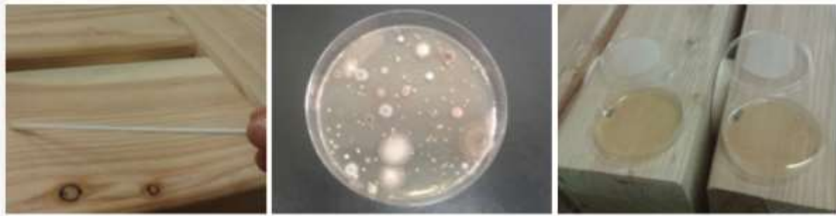
Obr. 9.: Metódy použité pri mikrobiologických testoch (zľava doprava): metóda sterov, metóda odtlačkov, spádová metóda
