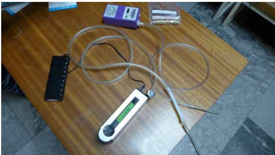
Obr.10: Skúšobné zariadenie pre VOC- emisie pri pôvodnom stave, uskutočnené sorpčnými tyčinkami naplnenými látkou Tenax®TA na 60 minút za použitia vzorkovacie pumpy pri prietoku vzduchu 100 mL min -1 .
