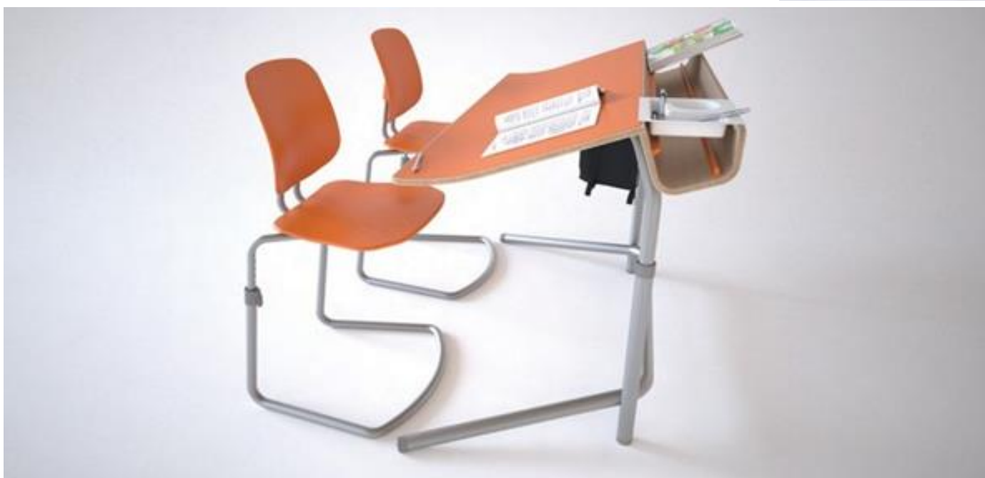
Demonštrácia flexibilnej a pevnej časti sedadla na stoličke Perch, poloha 02 a 03 naznačujú situáciu, keď je sedák zaťažovaný stehnami sediaceho žiaka. (Janecová, 2013), www.perch.ie
